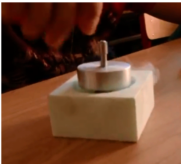
Obrázek 16 Setrvačnick levitující na magnetickém polštáři
